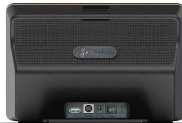
Auf der Rückseite finden Sie den USB-Anschluss (zum Anschluss von USB Sticks für Updates oder PGN Exporte), den Anschluss für das Schachbrett, die Strombuchse, den EIN/AUS-Schalter, die Kontroll-LED sowie den Reset-Taster.
